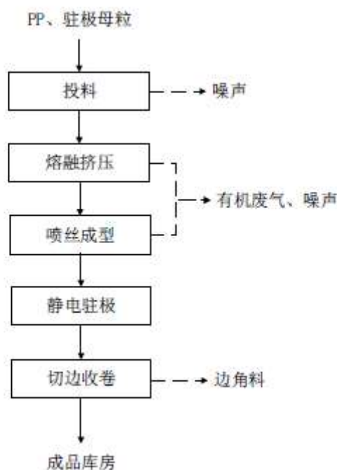
图 2-2 熔喷布生产线工艺工艺流程及产物节点图
